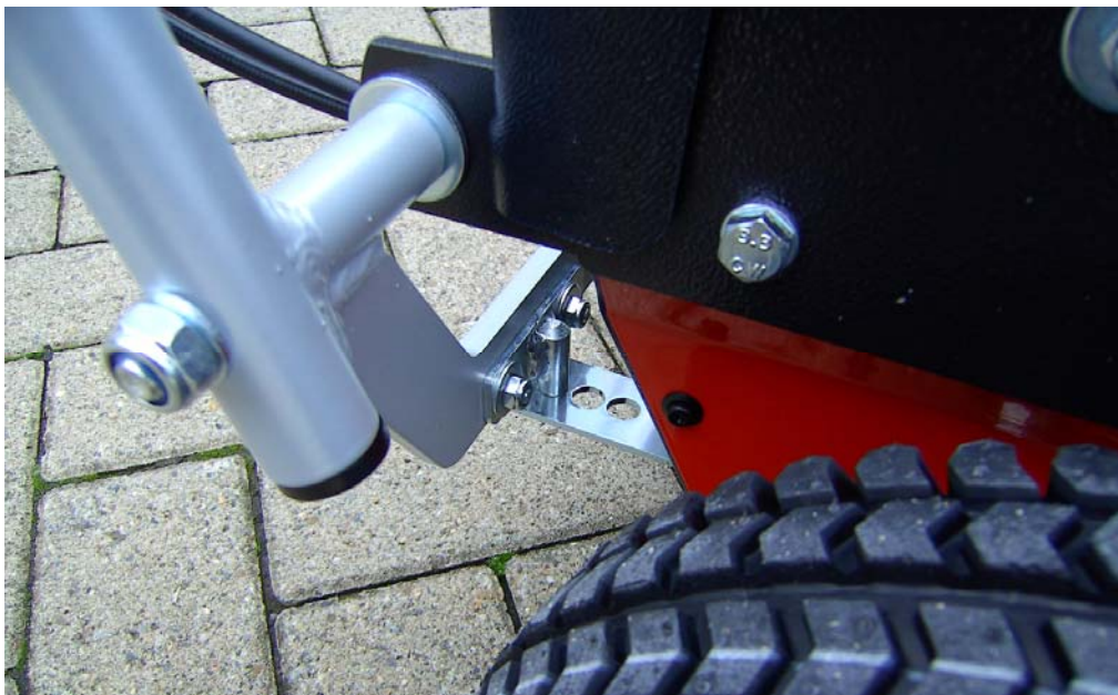
Abbildung 6: korrekte Montage des Rastfingers
